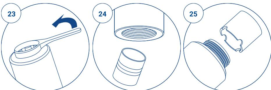
4. Снимите крышку с нового дозатора и вставьте его открытой стороной вверх.
