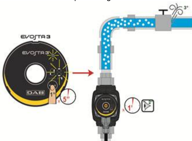
Figura 9: Drenagem automática da bomba
