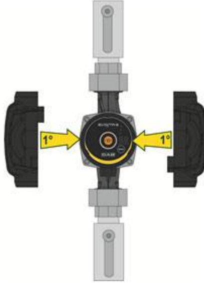
Resim 7: Pompa gövdesinin yalıtımı
