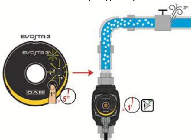
Рисунок 9: Автоматическое удаление воздуха из насоса
