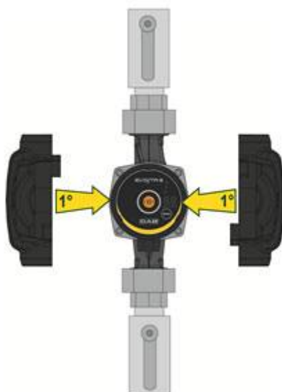
Afbeelding 7: Isolatie van het pomphuis
