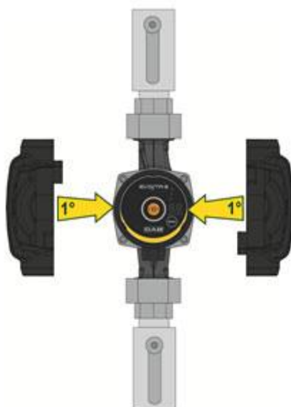
Fig 7: Isolering av pumphuset
