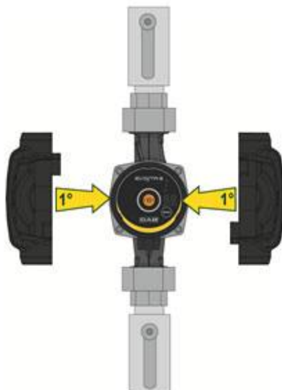
Obrázek 7: Izolace tělesa čerpadla
