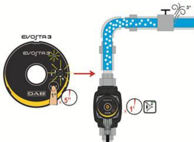
Afbeelding 9: Automatische ontluchting van de pomp
