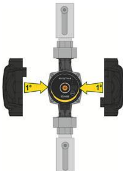
Figura 7: Izolare corp pompa
