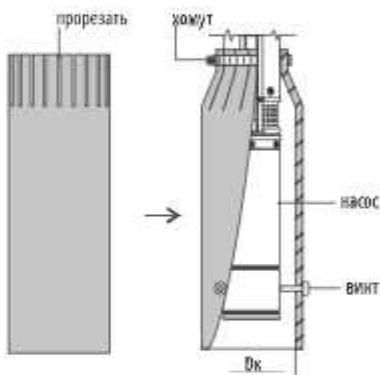
Расчеты показывают, что внутренний диаметр кожуха можно выбрать в диапазоне 110мм - 150мм.
