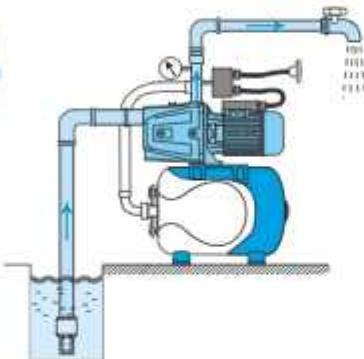
**Рис.14** Когда давление воды в системе понижается до настроенного уровня - **давления включения**, реле включает насос
