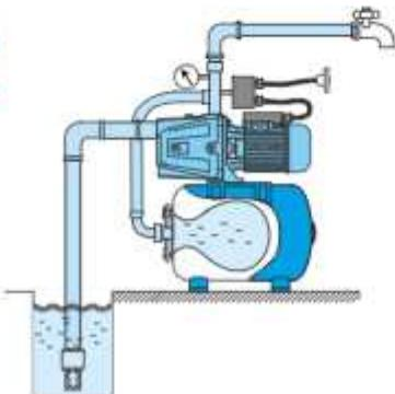
**Рис.12** Когда давление воды в системе достигает определенного значения - **давления отключения**, реле выключает насос.
