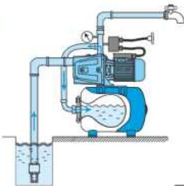
**Рис.11** После успешного запуска можно перекрыть воду на выходе из напорной магистрали.
