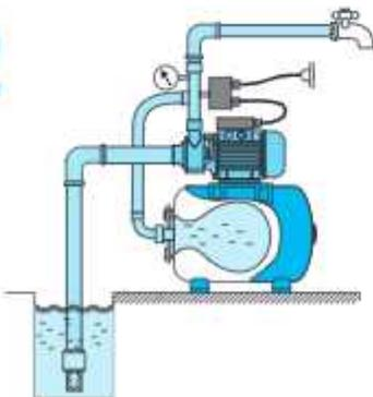
**Рис.8** Когда давление воды в системе достигает определенного значения - **давления отключения**, реле выключает насос.
