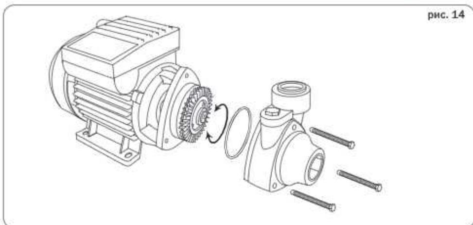
Чтобы минимизировать риск блокировки колеса по окончании периода эксплуатации насоса, необходимо полностью удалить воду из насосной части.
