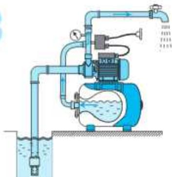
**Рис.9** При возобновлении водоразбора, вода, находящаяся в гидроаккумуляторе под давлением, начинает поступать потребителю. Давление в системе при этом постепенно снижается, а насос остается выключенным
