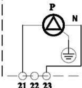
Рис. 39 Схема подключения многофункционального реле
