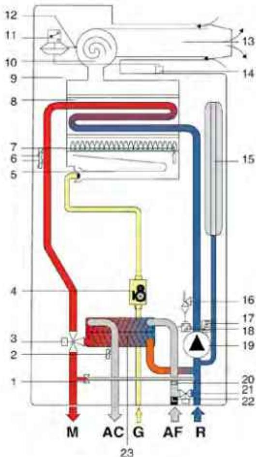
Рис. 7 Гидравлическая схема котла (мод. CTFS)
