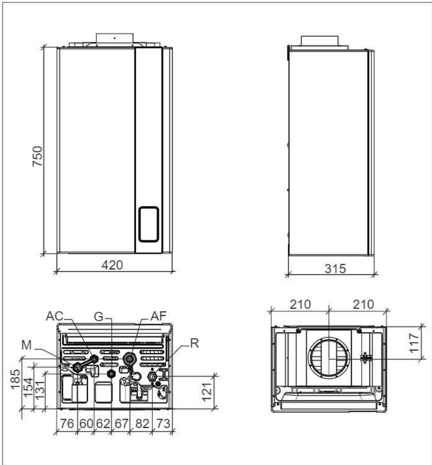
Рис. 2 Габаритные размеры СТН
