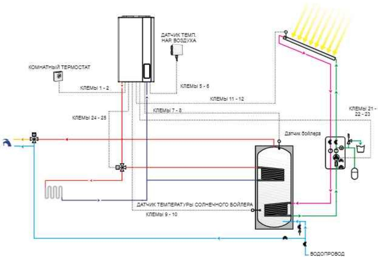
Рис. 38 Схема подключения системы солнечных коллекторов с принудительной циркуляцией к одноконтурному котлу
