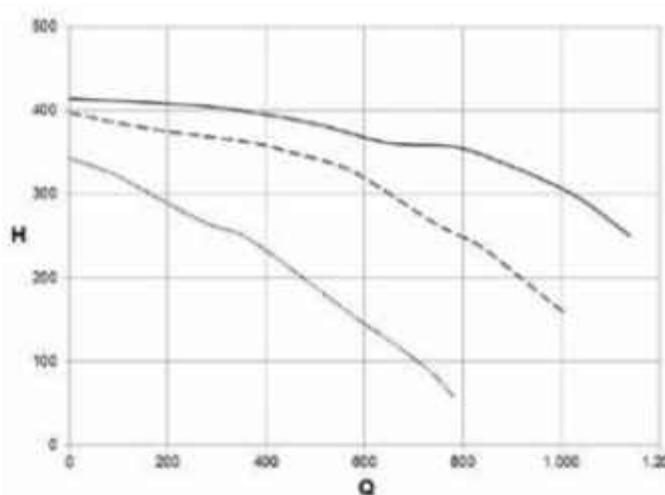
Рис. 23 Располагаемый напор CTFS/RTFS/RBTFS 24
