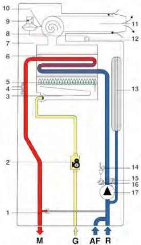
Рис. 9 Гидравлическая схема котла (мод. RTFS)
