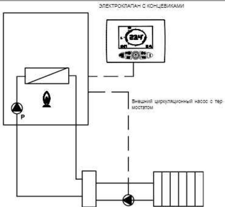
Рис. 41 Работа реле по внешнему запросу (Р17=1)
