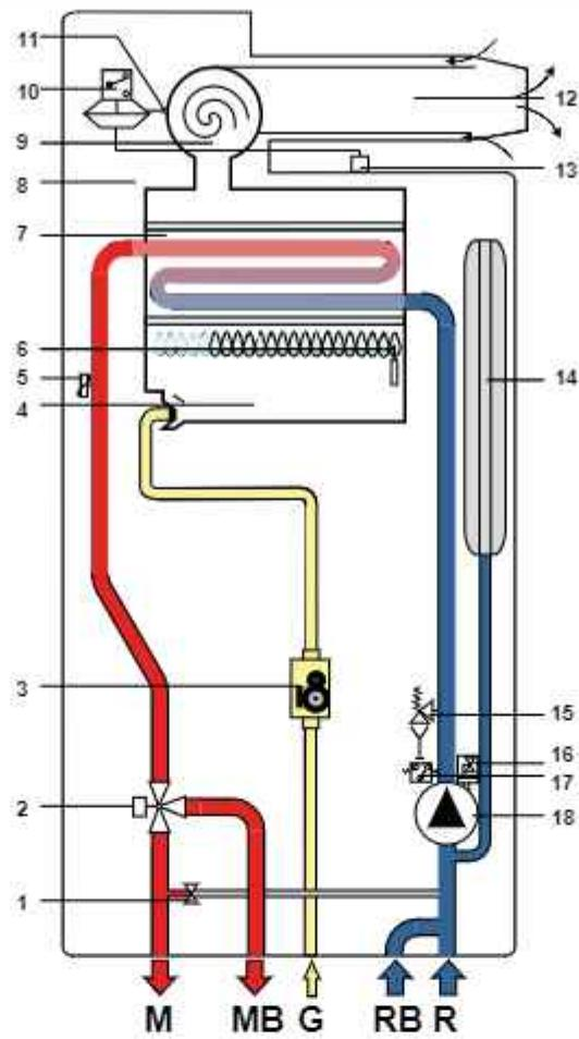
Рис. 11 Гидравлическая схема RBTFS
