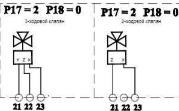
Рис. 37 Схема подключения многофункционального реле (X = общий; Y = на котел; Z = на коллектор)
