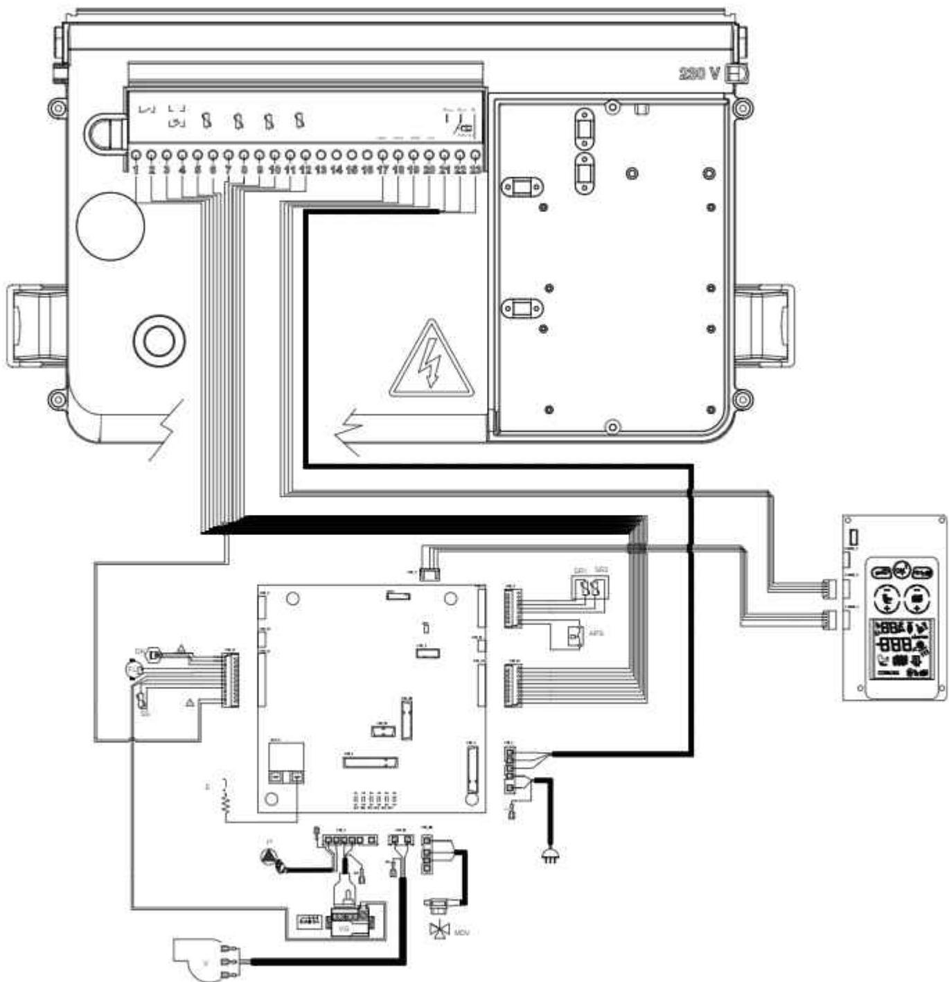
Рис. 28 Электрическая схема CTFS
