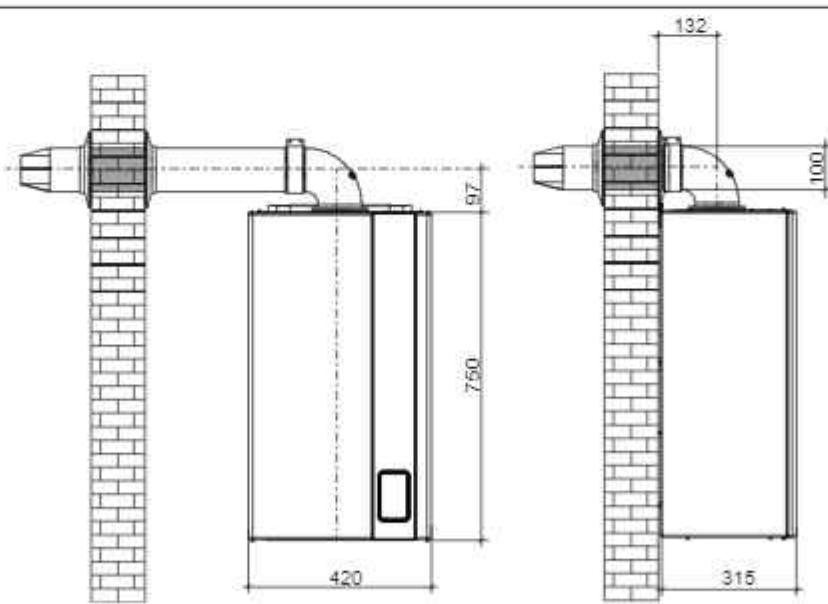
Рис. 18 Резмеры для подсоединения к коаксиальному трубопроводу забора воздуха/отвода дымовых газов
