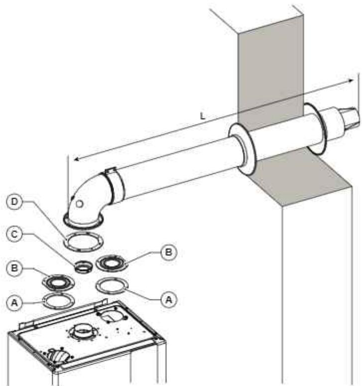
Рис. 17 Забор воздуха и отвод отработанных газов при помощи коаксиальных труб
