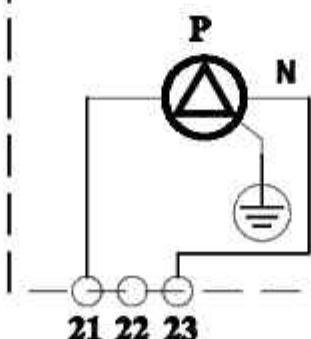
Рис. 35 Схема подключения многофункционального реле
