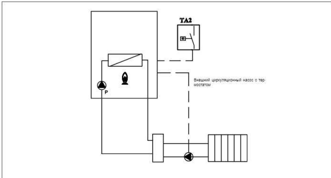
Рис. 42 Работа реле по внешнему запросу (P17=3)
